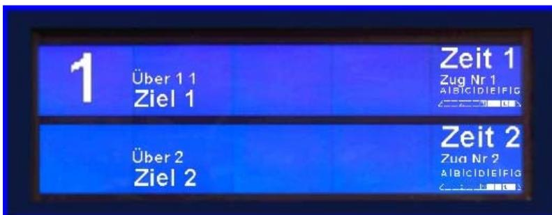
(Anzeigemöglichkeit bei Bahnsteigbelegung mit zwei Zügen oder bei Zugteilung. Wagenstand von oben nach unten: ABC\_1, Wagenstand\_1, ABC\_2, Wagenstand\_2)
