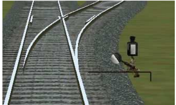
Abbildung 2: Weichen Grundstellung rechts, nicht in Grundstellung, Weichenantrieb_ort_-re
