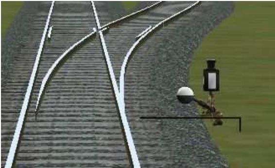
Abbildung 1: Weiche Grundstellung links, in Grundstellung, Weichenantrieb_ort_+li
