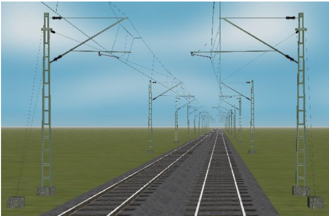
Abbildung 52: Festpunkt, Ankermasten
